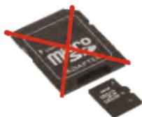
**Не используйте адаптер microSD-SD для установки microSD карты в слот SD. Данный адаптер предназначен только для подключения к ПК, и не используется в мобильных устройствах подверженных вибрации.**
