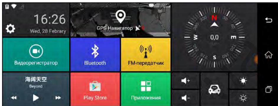
После включения устройства оно автоматически войдет на главный экран, с которого можно перейти на другой рабочий экран (необходимо провести пальцем вправо или влево), а также отображается информация о системном времени, состоянии видеорегистратора, средств связи Bluetooth, WiFi и FM-передатчика (в зависимости от того, используются ли эти функции системой).
