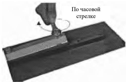
Поворот по часовой стрелке увеличивает расстояние между ручкой лезвия и лезвием
