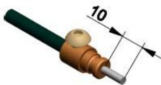
7. Разблокируйте замковое устройство, полностью вытянув цилиндр с ключом на себя. Обрежьте трос, оставив конец, выходящий из втулки длиной 10 мм. На конец троса наденьте ригель запирающего механизма до упора во втулку. Затяните стопорный винт ригеля. Выступление винта за наружный диаметр штыря не допускается. Если выступание осталось, сточите выступающие кромки винта надфилем.
