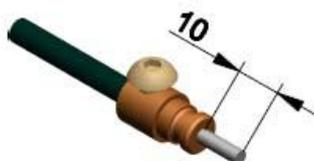
7. Разблокируйте замковое устройство, полностью вытянув цилиндр с ключом на себя. Обрежьте трос, оставив конец, выходящий из втулки длиной 10 мм. На конец троса наденьте ригель
