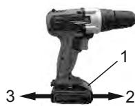
1. Для снятия батареи, удерживая инструмент за рукоятку, нажмите на кнопку фиксатора аккумулятора(1), и потяните его, как указывает стрелка 2, чтобы снять батарею.
