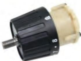
при сверлении отверстий в различных материалах есть возможность регулировки крутящего момента. Кольцо регулировки имеет шкалу от 0 до 8. Для установки нужного показателя совместить цифру на кольце регулятора со стрелкой на верхней части корпуса. Данной функцией обладает лишь сетевой шуруповерт модели **PBM10-C1**, две другие модели подобной функцией не обладают.
