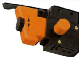
точно по центру клавиши расположен контроллер скорости (черная кнопка), который используется для ограничения максимальной скорости инструмента, во избежание чрезмерного усилия, которое может привести к поломке устройства. При вращении по часовой стрелке скорость увеличивается, при вращении против часовой стрелки скорость уменьшается.
