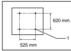
1. Диаметр отверстия - 8 мм
