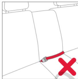
Со сложенной системой Seatfix детское автокресло может использоваться на всех сиденьях автомобиля с трехточечным ремнем безопасности, допущенных в руководстве к автомобилю для «универсального» использования.
