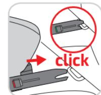
Vérifiez les indicateurs de sécurité. Ces deux éléments doivent être ROUGE. Si les indicateurs de sécurité (ROUGE) ne sont pas visibles, appuyez sur les boutons de déverrouillage jusqu'à ce que vous entendiez un >>CLICK<<.
