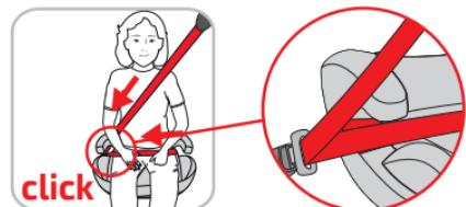
Следите, чтобы подтягивание поясного ремня проводилось с двух сторон через нижние направляющие (C) бустера, а диагональный ремень подтягивать только со стороны через нижнюю направляющую (C), находящуюся на пряжке ремня.
