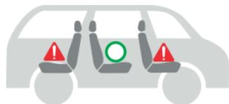
При использовании детского автокресла на переднем пассажирском сидении автомобиля, максимально отодвигните пассажирское сидение назад и следуйте указаниям руководства по эксплуатации автомобиля. Отключите подушку безопасности пассажира. Не используйте автокресло при неотключаемой подушке безопасности.
