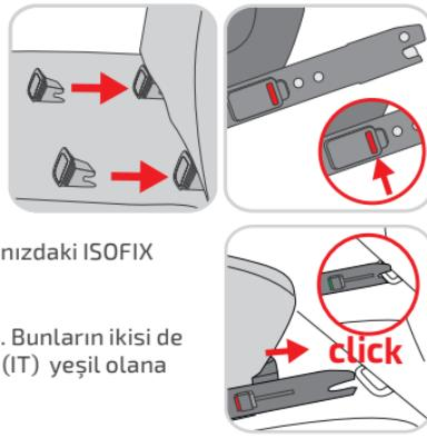
ISOFIX montaj noktaları, koltuk oturma yeri ile koltuk sırt dayama kesimi arasında bulunur.
