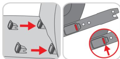
Πριν τοποθετήσετε το Safe UP Fix L στο κάθισμα του αυτοκινήτου, στερεώστε, εάν χρειάζεται, στο οχημά σας τα δύο παρεχόμενα βοηθήματα τοποθέτησης (IΗ) στις υποδοχές ISOFIX (ΙΑ). Τα σημεία στερέωσης ISOFIX βρίσκονται μεταξύ της έδρας και της πλάτης του καθίσματος αυτοκινήτου.
