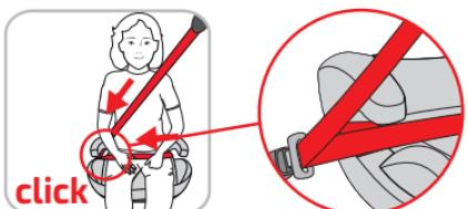
Položte MaxiFix PLUS na autosedačku, dajte svoje dieťa do posilňovača a zaistite ho brušným (O) a diagonálnym pásmom (N) trojbodového bezpečnostného pásu.
