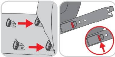
Перед установкой Safe UP Fix L на сиденье автомобиля, закрепите при необходимости два входящих в комплект поставки вспомогательных крепления (IH) на ISOFIX-анкерные скобы (IA) в Вашем автомобиле.
