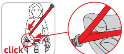
Stellen Sie den MaxiFix PLUS auf den Autositz, setzen Sie dann das Kind auf den Booster und sichern Sie das Kind mit Becken- und Diagonalgurt des Dreipunktgurtes.
