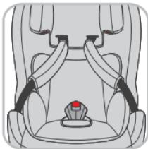
Fügen Sie die beiden Schlosszungen (**C**) des Hosenträgergurts (**G2**) zusammen und verbinden Sie diese mit dem Gurtgeschloss (**D**) bis ein deutliches »click« zu hören ist.
