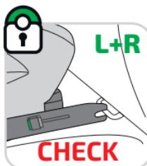
Bitte prüfen Sie anhand der Sicherheitsindikatoren an **BEIDEN SEITEN**, ob der Sitz richtig mit den beiden ISO-FIX-Ankern (**IA**) des Autos verbunden ist.
