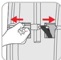
Между ремнями безопасности и телом ребенка должна проходить разжатая кисть взрослого, не больше. Если Ваш автомобиль оснащен механизмом регулировки штатных ремней безопасности по высоте, отрегулируйте ремни так, чтобы их высота соответствовала росту ребенка. Периодически проверяйте настройку ремней безопасности и их регулировку по высоте для подстройки ремней под
