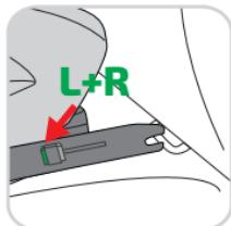
Теперь Вы можете нажать на кнопки (**IK**) замков системы ISOFIX для того, чтобы отсоединить ISO-FIX-коннекторы автокресла от ISOFIX-кронштейнов (**IA**) автомобиля.
