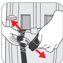
Danach können Sie die Hosenträgergurte (**G2**) und die Schulterpolstergurte (**SG**) aus der Verstelleinrichtung lösen und die beiden Gurtenden durch die Schultergurtdurchführungen (**G1**) herausziehen.
