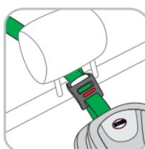
Для того, чтобы найти кронштейн крепления ремня TOP-TETHER воспользуйтесь инструкцией по эксплуатации автомобиля.
