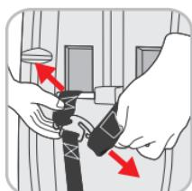
Um den Schrittgurt zu entfernen schieben Sie den Gurt zusammen mit der Metallplatte von unten nach oben aus dem Sitzteil.
