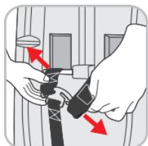
Ослабьте плечевые лямки ремней, нажав на кнопку фиксации натяжения ремней (**GV**). Удерживая кнопку фиксации натяжения ремней, вытяните плечевые лямки ремней (**G2**) на себя.
