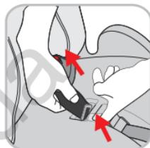
Для того, чтобы снять центральную лямку ремня безопасности, пропустите удерживающую ее металлическую пластину через соответствующее ей отверстие на дне сидения.
