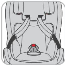
Соедините язычки замка безопасности (**C**) плечевых ремней (**G2**) и вставьте их в замок ремней безопасности (**D**). Ремень застегнут правильно, если Вы услышали "щелчок".
