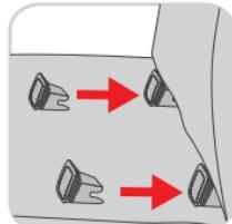
Legen sie den Top Tether (**TT**) über den Kindersitz. Stellen Sie den **HEYNER® MultiRelax AERO Fix** Kindersitz in Fahrtrichtung auf den Autositzen. Überprüfen Sie die Sicherheitsindikatoren an den Rasterarmen. Diese müssen beide rot sein. Sind die Sicherheitsindikatoren grün, müssen sie vor dem Verbinden die Rasterarme (**IM**) entriegeln, indem sie die
