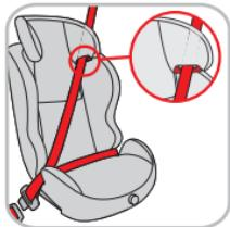
ремнем безопасности. Дополнительная фиксации системой ISOFIX (I) предназначена для того, чтобы автокресло не съезжало. Пожалуйста, следуйте указаниям параграфа 1.3. данной инструкции.
