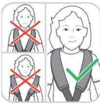
Die Kopfstütze kann in 10 verschiedene Positionen erfolgen. In Gruppe I können 5 verschiedene Höhen eingestellt werden. Wenn der 5-Punkt-Gurt entfernt wird, stehen 5 weitere Positionen zur Verfügung. Überprüfen Sie den Verlauf der Gurte und die Höhe der Kopfabstützung von Zeit zu Zeit und passen Sie diese dem wachsenden Kind an.
