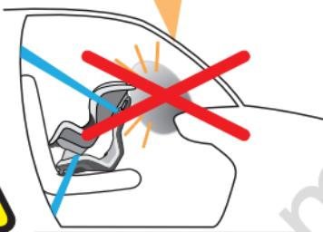
**ATTENTION:** ne pas installer de siège pour enfant tourné vers l'arrière sur un siège avant équipé d'un coussin gonflable. RISQUE DE MORT OU DE BLESSURE GRAVE
