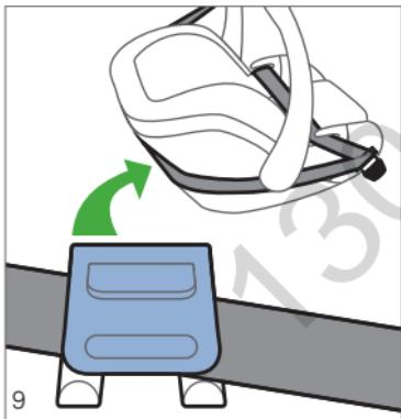
Estrarre la cinghia per le spalle dalla guida sull'autovettura e posizionarla attorno alla parte superiore del seggiolino auto.
