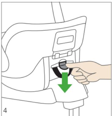
Dann entriegeln Sie die Höhenverstellung an der Rückseite der Babyschale durch Drücken der Taste nach unten und bringen die Kopfstütze in die passende Position. Achten Sie darauf, dass die Gurtumlenkung in der neuen Position einrastet.
