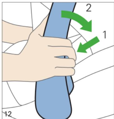
Для того чтобы изменить положение ручки для переноски, одновременно нажмите на две серые кнопки на ее корпусе и установите в желаемое положении. Затем отпустите ручку, внимательно проверив, что она прочно зафиксирована в новом положении.
