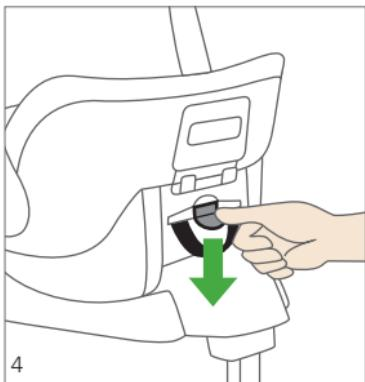
Разблокируйте регулировку по высоте, нажав на кнопку, расположенную с обратной стороны люльки, и установите подголовник в нужное положение. Проследите за тем, чтобы замок ремня защелкнулся в новом положении.
