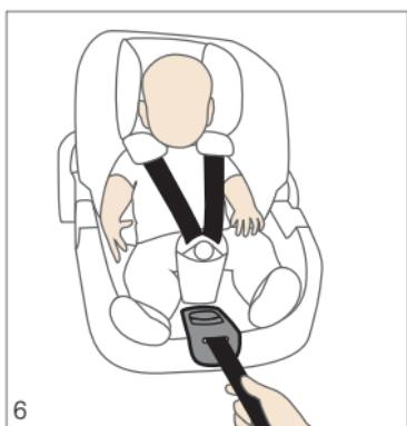
Straffen Sie den Gurt durch Ziehen am Verstellgurt. Je straffer der Gurt an Ihrem Kind anliegt, desto sicherer ist es in der Babyschale aufgehoben. Es ist deshalb zu empfehlen dicke Jacken oder Pullover im Fahrzeug auszuziehen.
