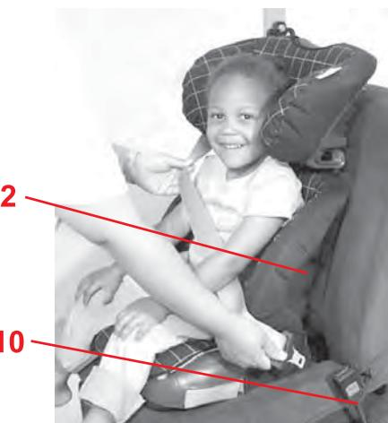
Усадите ребенка в детское сиденье. Вытяните автомобильный ремень и уложите его перед ребенком к замку автомобильного ремня **10**. **Внимание!** Не допускать скручивания ремня. Зафиксируйте язычки в замке автомобильного ремня **10**. Щелк!
