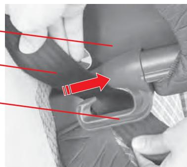
Pase el cinturón diagonal **6** por el soporte de color rojo oscuro **7** del reposacabezas **3**, hasta que se deslice por detrás de la lengüeta de bloqueo.
