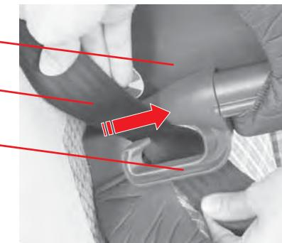
☞ Führen Sie den Diagonalgurt **6** in den dunkelroten Gurthalter **7** der Kopfstütze **3** ein, bis er hinter die Sicherungsnase rutscht.
