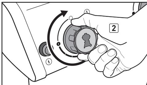
C) Откройте кран баллона, используя один из подходящих вариантов в зависимости от типа баллона и регулятора. См. "A)" в "ПРОВЕРКЕ НА УТЕЧКУ ГАЗА".
