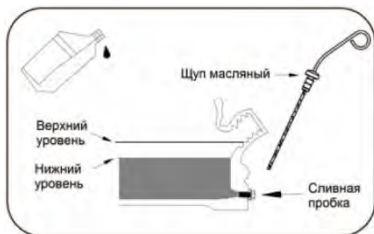
Рисунок 5. Отметки на масляном щупе.
