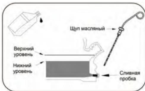
Рисунок 5. Отметки на масляном щупе.
