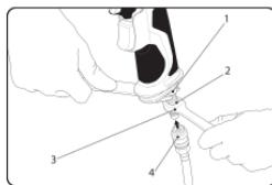
**ПРИМЕЧАНИЕ:** Перед первым использованием инструмента нанесите на входное отверстие 4-5 капель масла перед подключением шланга.
