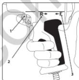
Проверьте установленное направление вращения. Для закручивания винтов и гаек установите переключатель направления вращения (1) в направлении F (3) (Forward/вперед). Для откручивания винтов и гаек установите переключатель в направлении R (2) (Reverse/назад).
