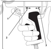
Überprüfen Sie die eingestellte Drehrichtung. Zum Festziehen von Schrauben und Muttern drücken Sie die Regulierschraube in Richtung F durch (Forward / Rechtslauf). Zum Lösen von Schrauben und Muttern drücken Sie die Regulierschraube in Richtung R durch (Reverse / Linkslauf).
