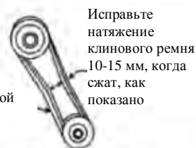
Рисунок 2. Натяжение клинового ремня
