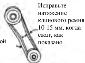
Рисунок 2. Натяжение клинового ремня
