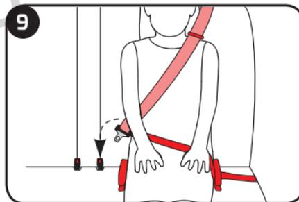
Извлеките ремень безопасности автомобиля и перекиньте его спереди через вашего ребенка. Протяните коленную часть ремня безопасности автомобиля через обе направляющие коленного ремня и соедините язычок пряжки ремня безопасности с пряжкой автомобильного кресла.
