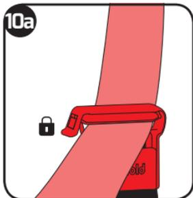
Чтобы установить направляющую плечевого ремня, прикрепите направляющую плечевого ремня безопасности к диагональной части ремня безопасности автомобиля, открыв зажим и вставив ремень безопасности. Затем закройте зажим.
