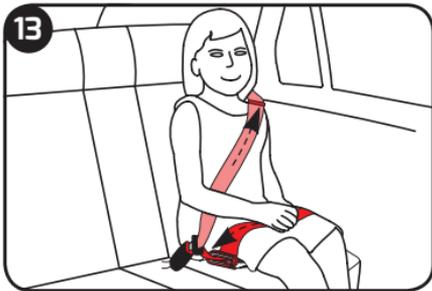
Устраните все перекручивания или провисание ремня, потянув сначала за коленную часть ремня, а затем за диагональную часть ремня безопасности для взрослых.
