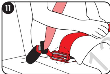
Вставьте только коленную часть ремня безопасности автомобиля в красные направляющие ремня с каждой стороны бустера.
