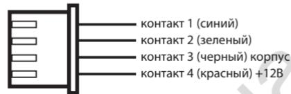
**Синий провод (контакт 1)** – импульсный вход внешнего запуска / остановки двигателя. Полярность запускающего импульса для системы определяется состоянием программируемой функции F.1.8. Длительность запускающего импульса по входу должна быть не менее 1сек.
