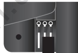
положение перемычки соответствующее выходному сигналу +3В
