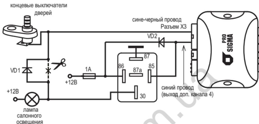
Дополнительный канал 4 также может быть использован для подключения к ближнему свету фар и реализации функции «световая дорожка». При подключении необходимо использовать дополнительное реле. Пример схемы подключения для канала №4 (синий провод 16-контактного разъема «X3»).
