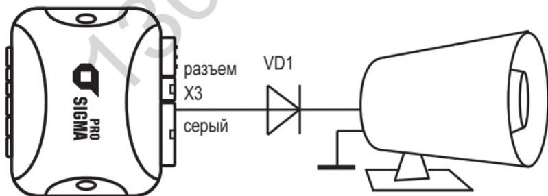
При подключении провода массы сирены необходимо обеспечить надежный контакт.
