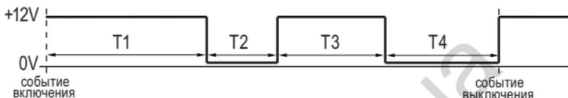
где: T1 - задержка первого импульса относительно события включения;
