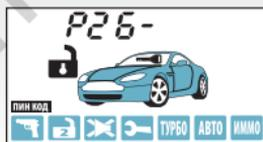
**7** Для выхода из режима установки выключите зажигание
