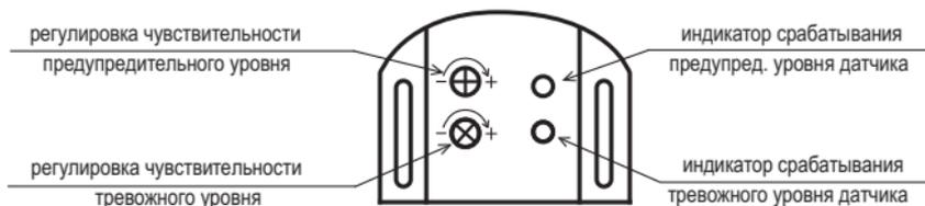
Первым настраивается предупредительный уровень. Для настройки необходимо открыть дверь автомобиля, включить режим охраны. Затем поочередно поворачивая регулировочный винт предупредительного уровня датчика по часовой стрелке и нанося легкие удары по кузову автомобиля (например на стыке рамок окон боковых дверей) добиться желаемого порога срабатывания. Затем необходимо настроить тревожный уровень датчика удара аналогичным образом.
