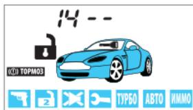
**вариант 4** - работа канала в режиме «зашелка», когда включение / выключение канала осуществляется дистанционно с брелка. На время работы канала в режиме охраны датчик удара и дополнительные датчики не отключаются.
