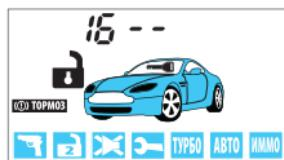
**вариант 4** - работа канала в режиме поддержки +12В на контакте IGN1 (15/1) замка зажигания при активации режима охраны с работающим двигателем. Поддержка зажигания происходит автоматически при работающем двигателе (или включенном зажигании) при затягивании ручного тормоза. Время нахождения в режиме поддержки зажигания не ограничено. Поддержка будет выключена при выключении зажигания или при отпускании ручного тормоза.
