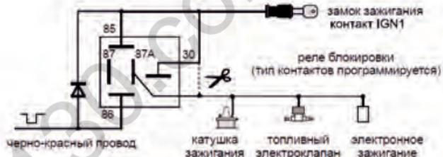
**Схема поддержки +12В на замке зажигания при работе двигателя в режиме охраны и режиме турботаймера**
