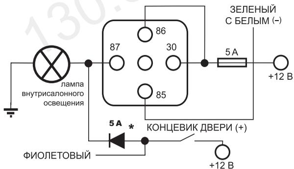
\* Дополнительный развязывающий диод (устанавливается при необходимости).
