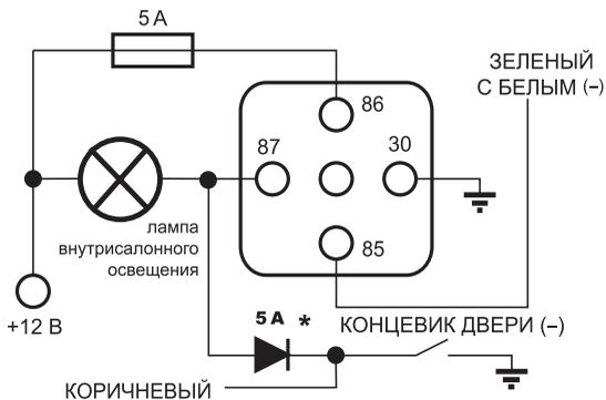
\* Дополнительный развязывающий диод (устанавливается при необходимости).
