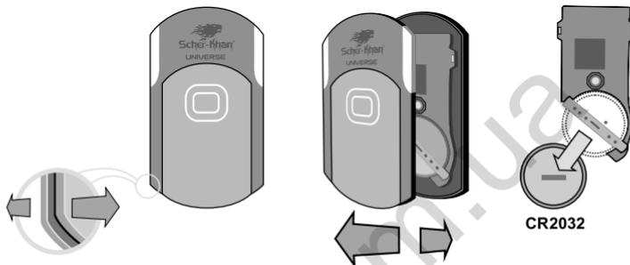
Установите элемент питания таким образом, чтобы надпись CR2032 смотрела вниз. На контактных пластинах держателя указана требуемая полярность. При появлении напряжения питания, соответствующего номинальному значению и полярности, брелок-метка подтвердит включение серией вспышек светодиода зеленого цвета.
