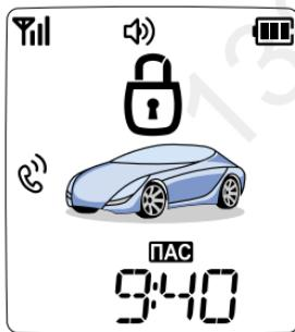
Если выбрано значение 4 программируемой функции 1-4 (см. стр. 67), то система в режим охраны не встает, а только включает блокировку стартера (зажигания) по истечении 30 сек. после выключения зажигания или по завершении режимов резервирования запуска, Pit-Stop и «Турбо». Для выключения блокировки стартера (зажигания) в этом случае необходимо кратковременно нажать кнопку 2 брелока. Выключенная таким образом блокировка снова активируется только после повторного
