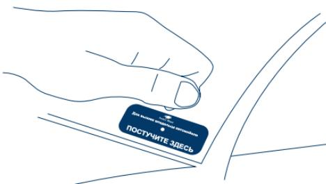
Использование персонального кода PIN 2 может потребоваться, когда система находится в режиме охраны для снятия с охраны и отпирания замков дверей или когда система снята с охраны для постановки на охрану и запирания замков дверей. После ввода кода PIN 2 система производит снятие с охраны и последующую постановку с запиранием замков дверей через 30 сек. (программируемая функция 1-5 должна быть в заводском значении, см. стр. 67).
