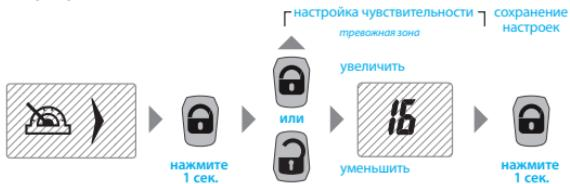
Короткими нажатиями кнопки производится увеличение чувствительности датчика движения или наклона, короткими нажатиями кнопки производится уменьшение чувствительности датчика.
