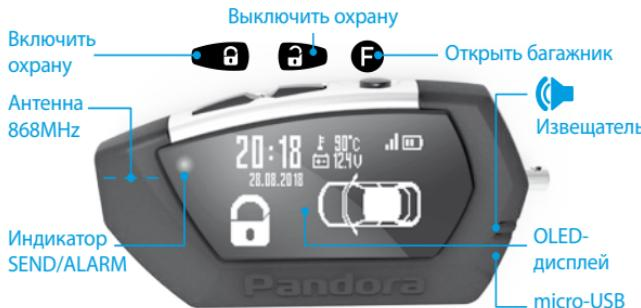
! Все команды управления передаются по радиоканалу, при работе с брелоком, для достижения максимальной эффективности и максимальной дальности радиообмена, рекомендуется не закрывать пальцами рук зону встроенной антенны (см. рисунок).
