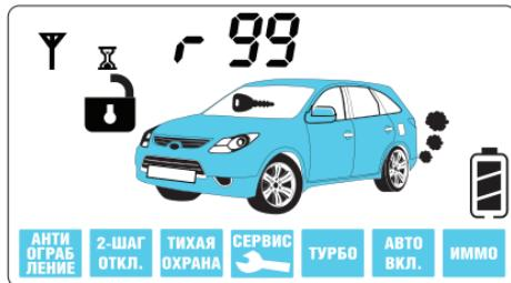
если запрограммирован режим турботаймера, то отобразятся иконки **г 01, г 02,**
