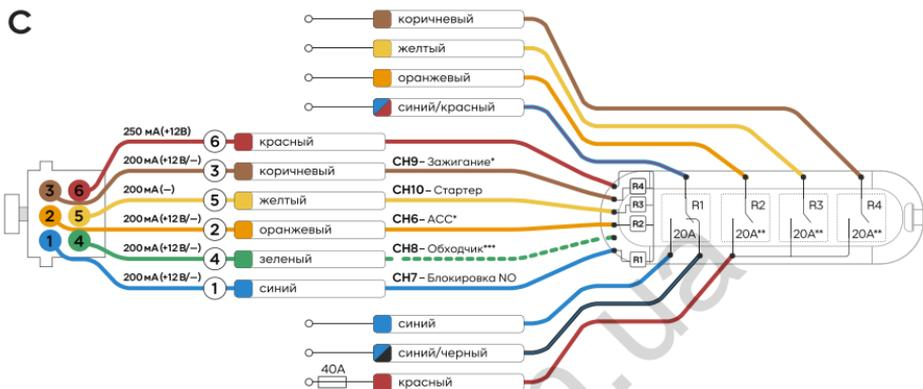
\*Пункт 2.2.1 – Автомобиль с кнопкой START/STOP («Зажигание» - «START/STOP», «ACC» - «Педаль тормоза»)
