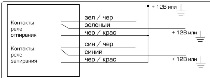
Схема подключения к двухпроводным приводам системы запираения
