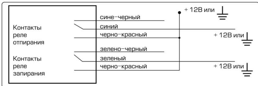
Схема подключения к двухпроводным приводам системы запирания
