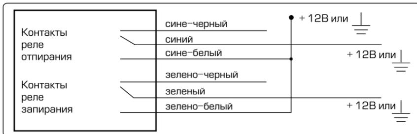
Схема подключения к двухпроводным приводам системы запирания
