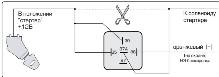
Схема подключение реле блокировки стартера НР контактами
