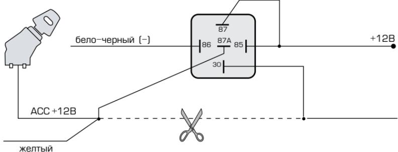
Схема подключения к соленоиду замка багажника с отрицательной полярностью
