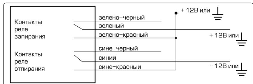
Схема подключения к двухпроводным приводам системы запирания
