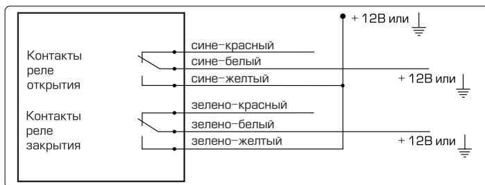
Схема подключения к системе с положительным или отрицательным управлением
