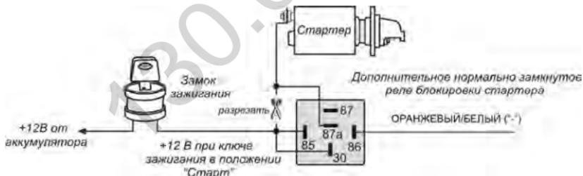
**3) ОРАНЖЕВЫЙ/БЕЛЫЙ** провод может быть также запрограммирован как «**выход для отпирания всех дверей**» для реализации функции отпирания дверей в 2 этапа при снятии системы с охраны.
