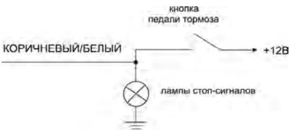
провод системы к проводу, идущему от стоп-сигналов автомобиля, на котором появляется +12 В при нажатии педали тормоза.
