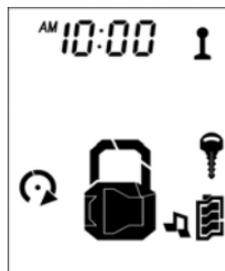
6. Если в то время, когда система находится в режиме охраны с работающим двигателем, зажигание будет выключено более чем на 3 секунды, система автоматически включит цепи блокировки двигателя и перейдет в обычный режим охраны.
