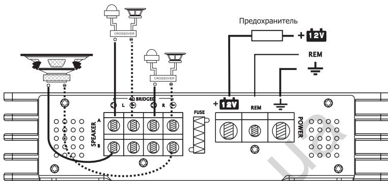
КЛАССИЧЕСКАЯ СХЕМА 4-Х КАНАЛЬНОГО ПОДКЛЮЧЕНИЯ
