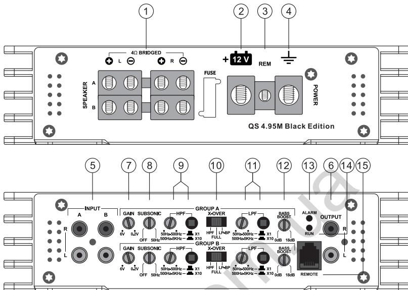
1. SPEAKER – Клеммы выхода усилителя для подключения динамиков
