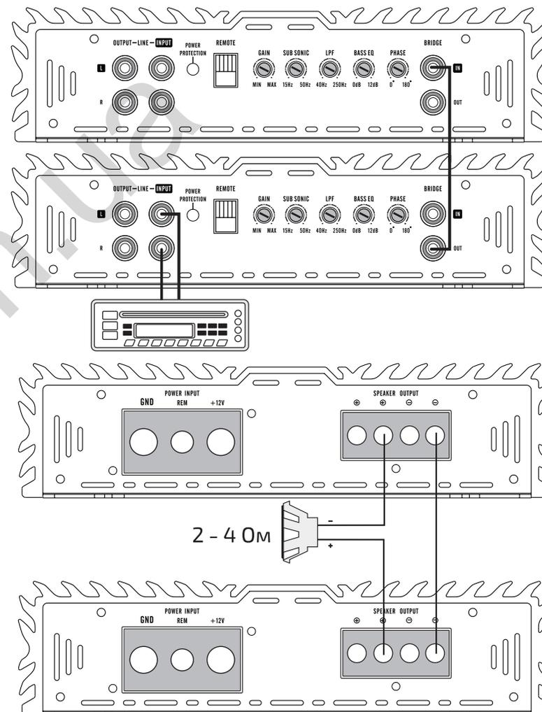
В мостовом подключении усилитель SLAVE получает сигнал от усилителя MASTER. **Не используйте** RCA входы на усилителе работающем в режиме SLAVE. Так же настройки необходимо выполнять на усилителе, работающем в режиме MASTER.
