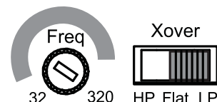
Funzionamento Low-Pass: Subwoofer e woofer
