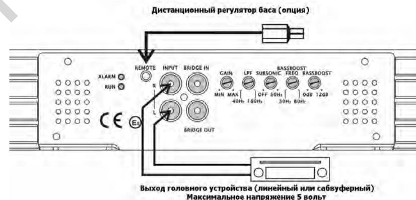
Для создания мощных аудио-комплексов одинаковые усилители можно включать попарно, в мостовую схему. Для этого соедините кабелем одиночным кабелем RCA BRIDGE IN одного усилителя с BRIDGE OUT второго, а к нагрузке проведите кабели от 2-х выходов, как показано на стр. 6
