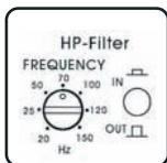
При установке переключателя HP-filter в положении OUT усилитель пропускает на акустические системы полный диапазон. Если по каким-либо причинам вы хотите ограничить воспроизведение самых низких частот, то включите HP-filter. Стандартной установкой в этом случае является частота 60 – 80 Гц.
