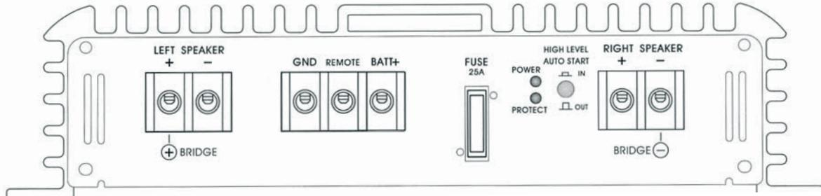
RA25 является двухканальным стереофоническим усилителем. Его можно использовать либо как стереофонический усилитель для подключения широкополосных акустических систем, либо как монофонический усилитель для сабвуфера, включенного в мостовом режиме.
