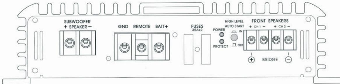
**RA30** является трехканальным стереофоническим усилителем. Его можно использовать для подключения одной пары фронтальных/тыловых широкополосных акустических систем и одного или нескольких сабвуферов, подключаемых к монофоническому каналу.
