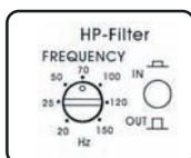
При установке переключателя **HP-filter** в положении **OUT** усилитель подает на акустические системы полный диапазон. Если по каким-либо причинам вы хотите ограничить воспроизведение самых низких частот, то установите переключатель **HP-filter** в положение **IN**. Стандартной установкой в этом случае является частота 60 – 80 Гц.
