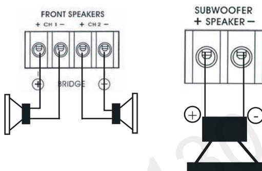
Усилитель RA30 допускает минимальное сопротивление нагрузки 2 Ом, поэтому возможно параллельное включение двух фронтальных акустических систем или двух сабвуферов.
