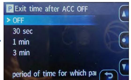
Задержка включения режима парковки после выкл. зажигания
