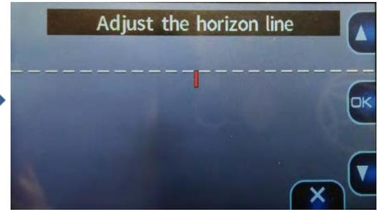
Установите линию по верхней кромке капота реального или виртуального, если нет реального
