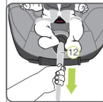
7. ЗАТЯЖКА РЕГУЛИРОВОЧНОГО РЕМНЯ
