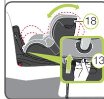
**Для регулировки угла наклона сиденья:** установите ручку регулировки наклона (13) вверх и потяните/сдвиньте корпус сиденья (18) в нужное положение.
