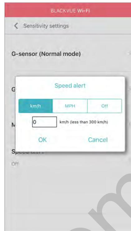
Установите ограничение скорости (до 300 км/ч или 200 миль/ч), чтобы активировать функцию оповещения при превышении скорости. При превышении автомобилем установленного скоростного ограничения раздается звуковой сигнал и включается режим записи события. После сохранения одного файла записи события видеорегистратор переходит обратно в режим обычной записи.
