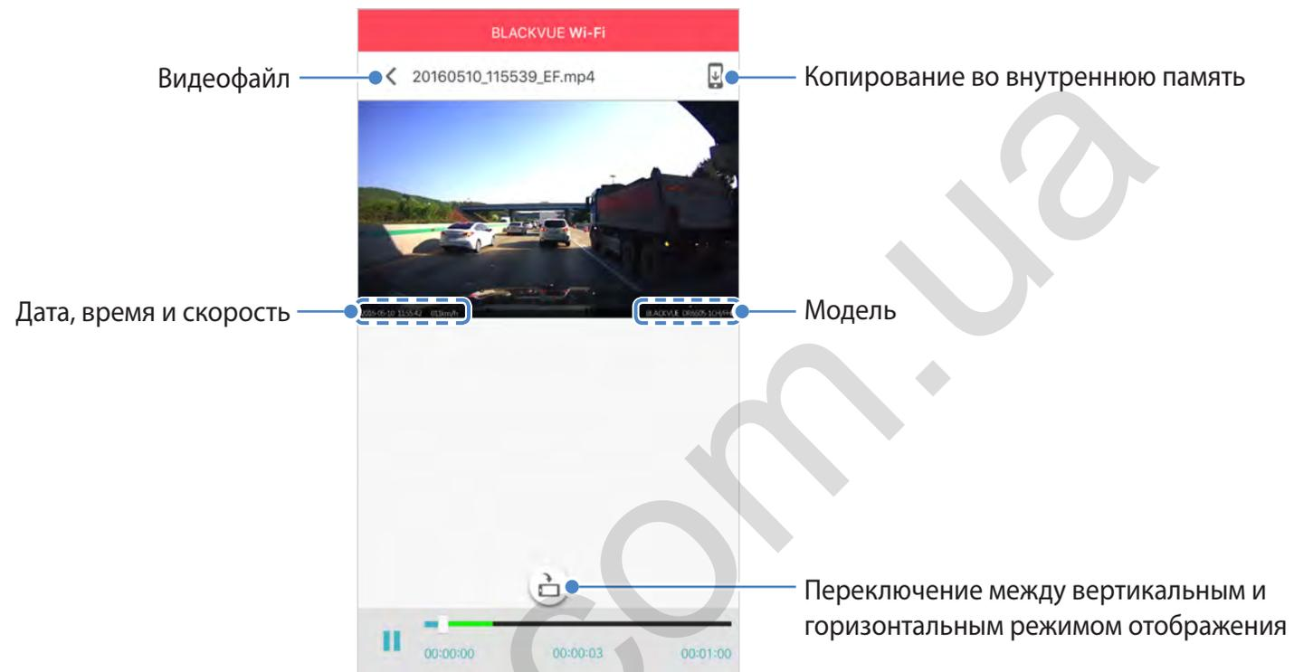
При воспроизведении скорость автомобиля отображается в левом нижнем углу видео.
