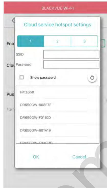
Можно сохранить до трех SSID точек доступа Wi-Fi (например, домашней сети, переносного устройства и рабочей сети). Выберите точку доступа Wi-Fi из списка и введите пароль. Нажмите 2 и 3 для настройки дополнительных точек доступа.
