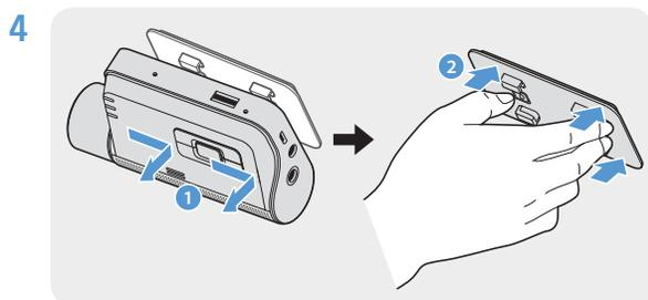
Отсоедините устройство от крепления, прижмите крепление к ветровому стеклу, чтобы надежно его зафиксировать.
