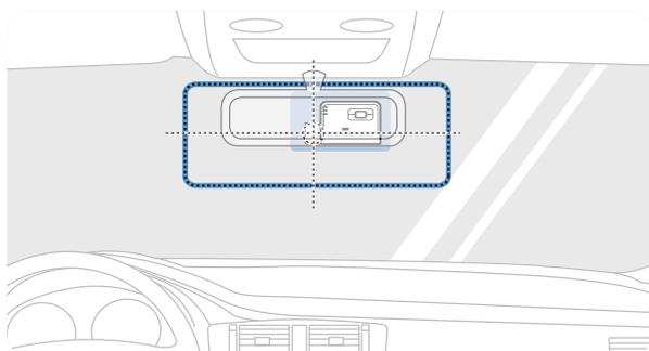
При установке расположите устройство таким образом, чтобы оно записывало все происходящее перед транспортным средством, не ограничивая обзор с места водителя. Убедитесь, что объектив передней камеры расположен в центре ветрового стекла.
