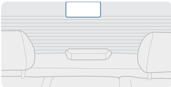
Выберите место на заднем ветровом стекле, где отсутствуют нити обогрева и где камера охватывает обзор позади автомобиля целиком.
