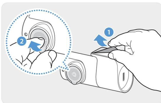
Удалите защитную пленку с клеящегося крепления и объектива камеры.
