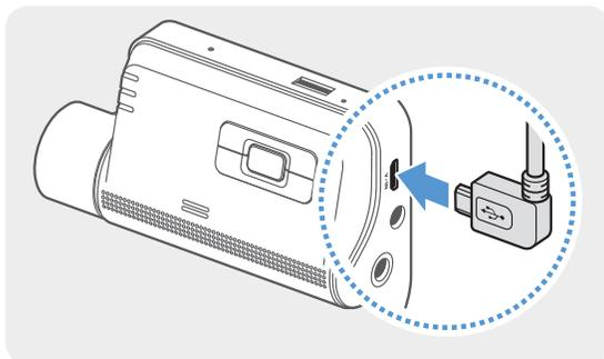
Один конец кабеля задней камеры подключите к разъему V-IN на передней камере.
