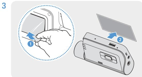
Удалите защитную пленку с клеящегося крепления и прижмите крепление к месту установки.
