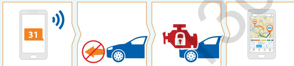
**Внимание!** При утере метки или разряде элемента питания на телефон придет SMS-оповещение и при включении зажигания двигатель будет заблокирован. Для продолжения поездки переведите трекер в сервисный режим (SMS-команда «51 xxxx», где xxxx — код экстренного выключения охраны) при включенном зажигании. Помните, что в сервисном режиме все охранные функции отключены!
