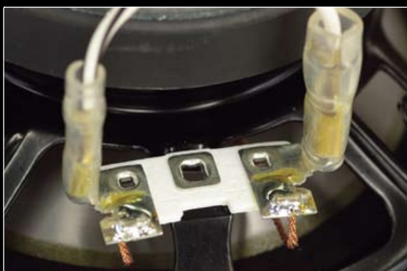
Установка универсальных АС требует подрезки проводки так, чтобы она соответствовала АС.
